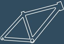
**Cadres:** L'aluminium constitue la structure principale du vélo et offre un excellent équilibre entre la solidité, le poids et la résistance à la corrosion. Il est également bien adapté au soudage et au façonnage des géométries complexes des cadres de vélo modernes.
